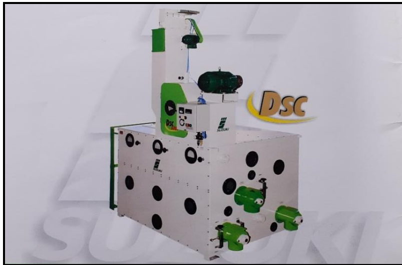
Figura 3: Folder apresentando a máquina de descascar e separar a casca do arroz
