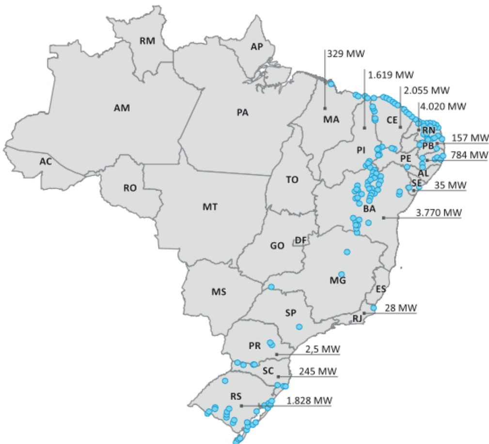
Figura 2 – Mapa ilustrando a localização e capacidade de cada parque eólico por Estado no Brasil.
